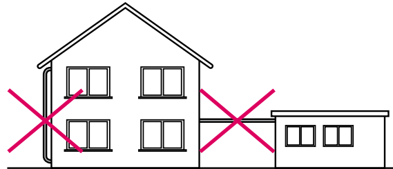
Sl. 29-9 Spoljašnja instalacija nije dozvoljena ili je dozvoljena samo za vodovodne cevi sa odgovarajućim zaštitnim merama
